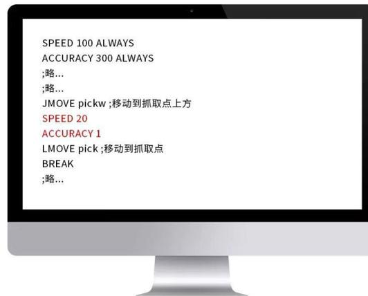
当存在有多个位置需要速度、精度可变的情况时，如果频繁地输入 SPEED、ACCURACY，将会大幅度增加程序的长度，而且不利于对程序进行维护及修改。
