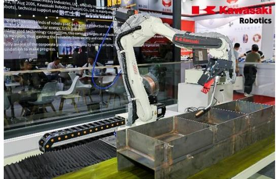
本单元适合用于有限的碳钢钢结构隔板，H型钢肋板等焊接件生产现场，主要以钢结构筋板平/立直角焊缝为主，在除尘设备、汽车零部件、工程机械、电力设备、环保设备等行业都有广泛应用。
